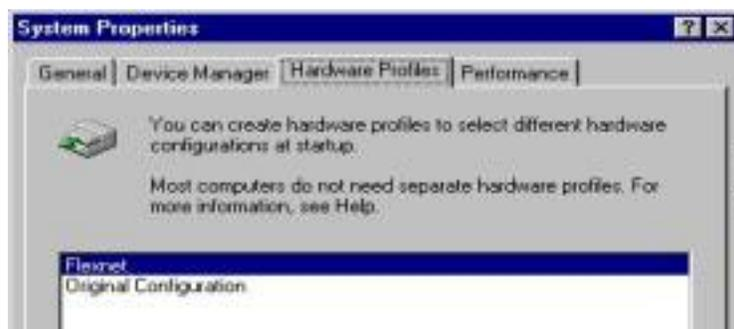
Pada profile ini, matikan piranti COM1, COM2, LPT1, Game Port atau Soundcard yang digunakan sebagai modem radio paket, atau tempat diletakkannya modem/PTT Keyer.
