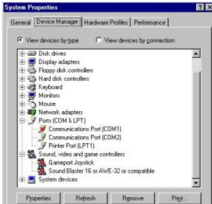
Saat komputer direstart, pilihlah profile “FlexNet”. Saat masuk ke Windows, kita siap menginstal drivernya PC/FlexNet.
